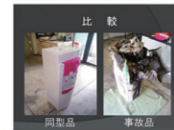
ウォーターサーバーから出火、 リコールに発展した事例
